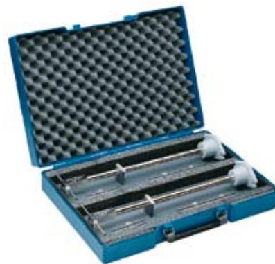
*Präzisions-Halbwellen-Dipolsätze R&S®HZ-12 (links) und R&S®HZ-13 im Handkoffer*
